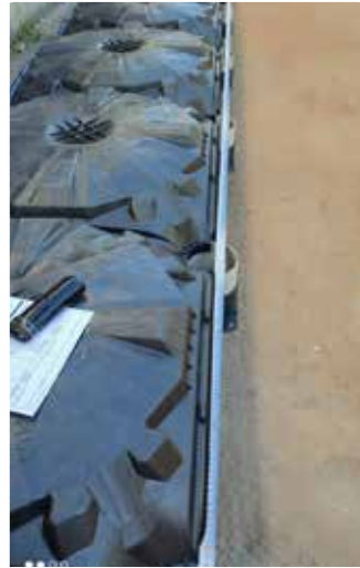
Üretim sonrası soğumuş ve dinlenmiş ürünlerin gerçek uzunlukları kontrol edilir.
